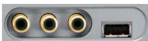
Entrée USB en façade pour une mémoire flash (MP3) ou un disque dur.
